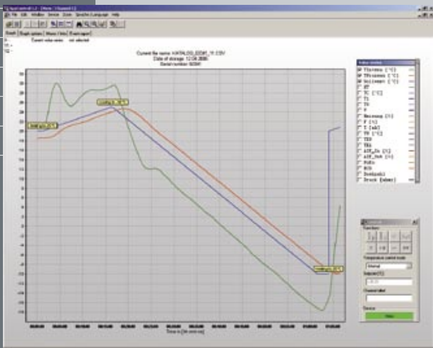
Симулирование экзотермической реакции в 20л реакторе с использованием погружного нагревателя мощностью 300 Вт
