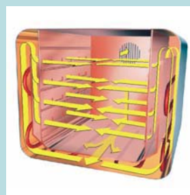
APT.Line®, циркуляция воздуха в камере с принудительной конвекцией
