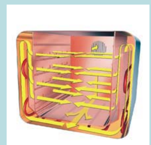
APT.Line®, циркуляция воздуха в камере с принудительной конвекцией
