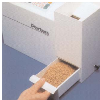
4. Высыпьте образец. Освободите приёмник от образца
